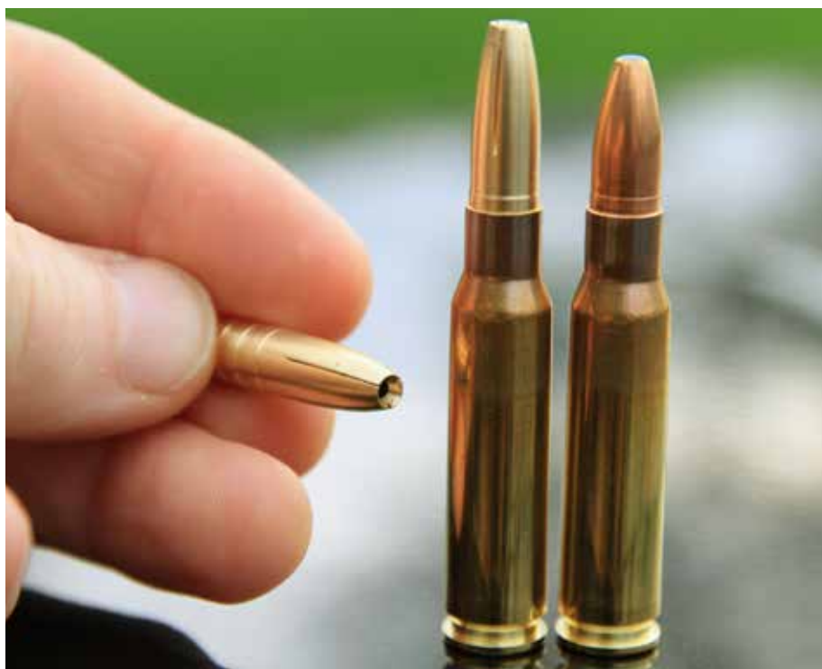
Et homogent Hunter projektilet i messing fra DK Bullets (tv) og et blyholdigt Lapua Mega (th). Begge .308 Win. Jeg forventer, at DK Bullets store hulspids med de tre afbrækkende flige giver en god effekt.
